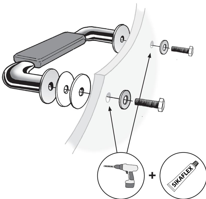
Mät ut var du vill ha fotsteget på båten och borra hål för bultarna i skrovet. Vid behov, använd passbrickorna för att få bästa passform och rätt vinkel ( $90^\circ$ ) på fotsteget. Täta med sikaflex eller liknande vid infästningarna.
